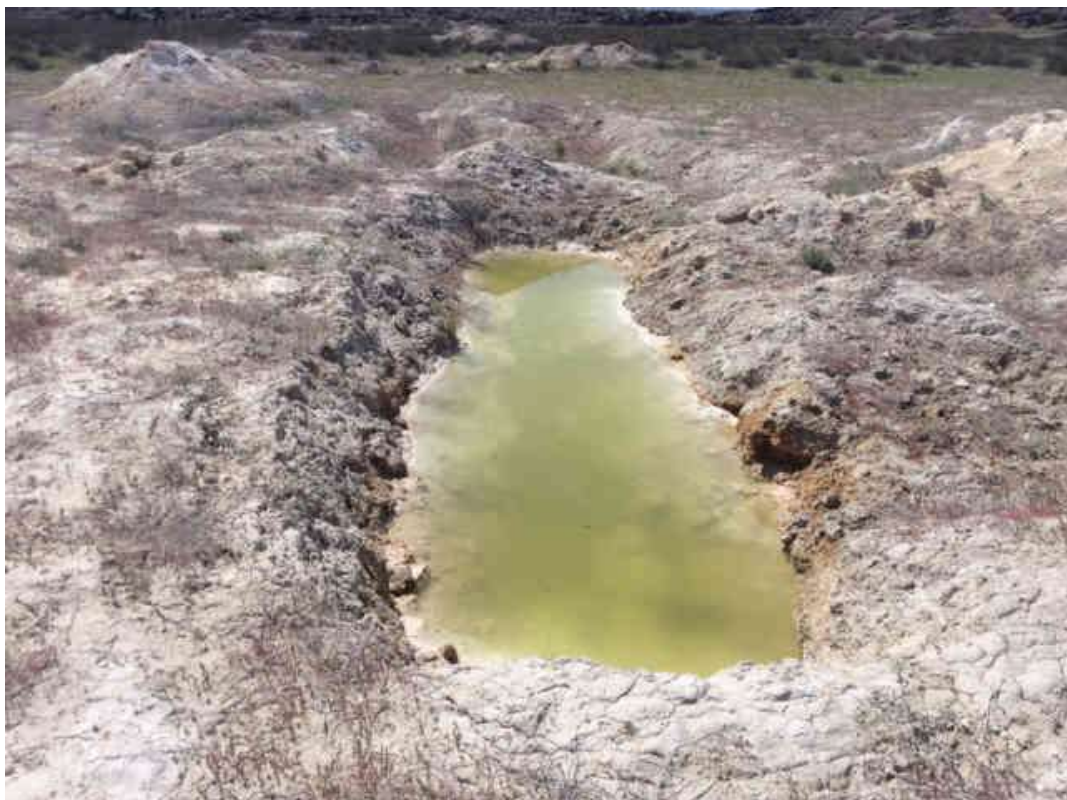
Abb. 70: Poldasht, Wasser Pol 4; mit Grundwasser gefüllter Trench im Magnesit.
